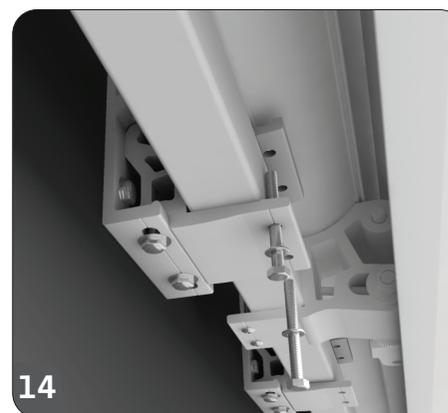
**07** - Emboîter le store/tube carré du coffre (n.º 12) dans le support (n.º 7). Appliquer les vis DIN933 M8 x 75 avec les rondelles et serrer jusqu'à ce que soit complètement sûr.
