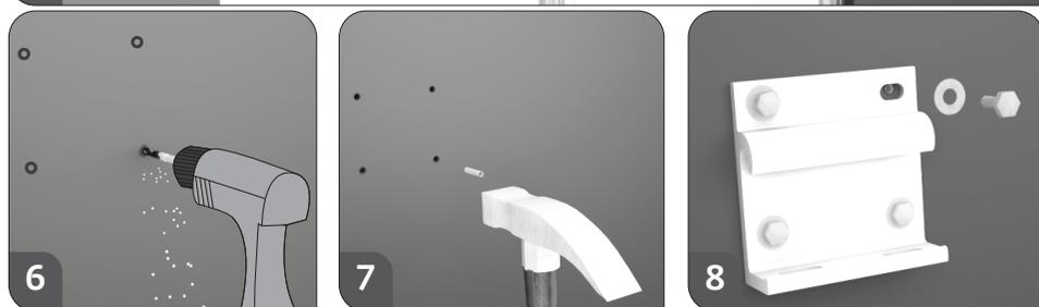
**03** - À l'aide d'un crayon ou d'un marqueur, identifier les points de forage, pour les emplacements des supports de mur (n.º 6). Faire les trous de 100 mm de profondeur et  $\varnothing$ 20mm.
